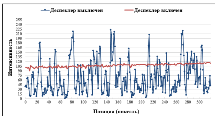
б) Распределение интенсивности излучения в поперечном сечении лазерного пучка за СЖК- ячейкой
