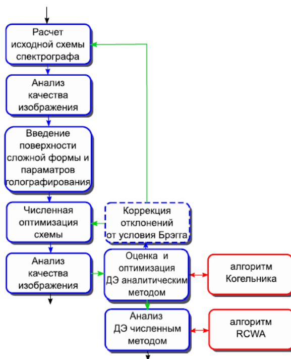
Рис. 6. Алгоритм расчета и моделирования спектрографов с голограммными решетками на поверхностях свободной формы
