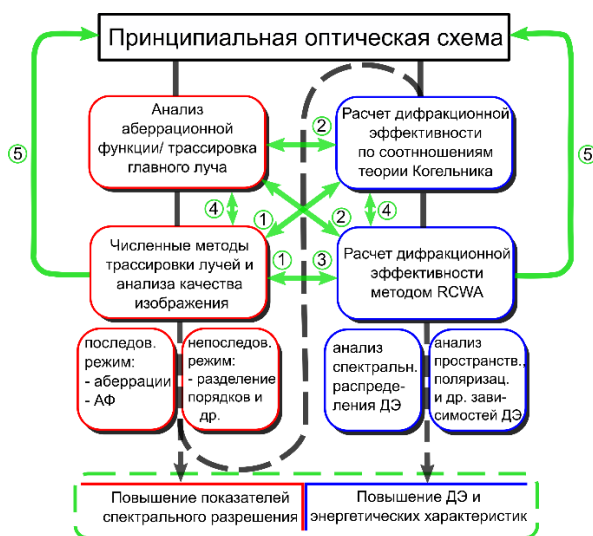
Рис. 1. Диаграмма применения методов расчета и оптимизации при проектировании спектрографов
