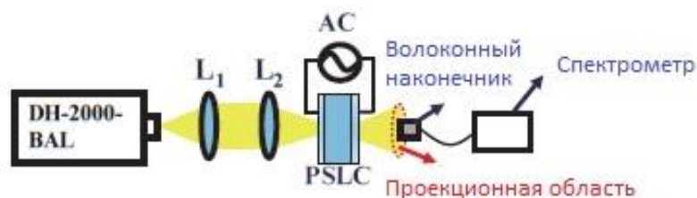
Рис. 6. Экспериментальная установка для получения модуляции света с помощью PSLC-ячейки при различном приложенном напряжении [13]
