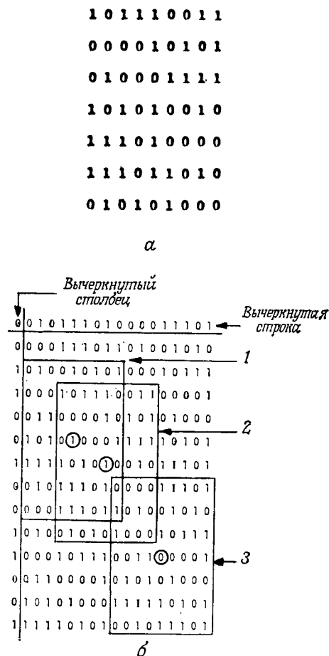
Рис. 6. Коррелятор сложных кодированных сигналов для 63-разрядного кода [8]. а — входной формат для случая, когда прием кода начинается с 1-го разряда; б — эталонная маска для синтеза согласованного пространственного фильтра (1 — положение корреляции для кода, начинающегося с 52-го разряда; 2 — то же для кода, начинающегося с 1-го разряда; 3 — то же для кода с 42-го разряда); в и г — картины на выходе в плоскости корреляции для случая начала приема кода с 42-го и 52-го разрядов соответственно.
