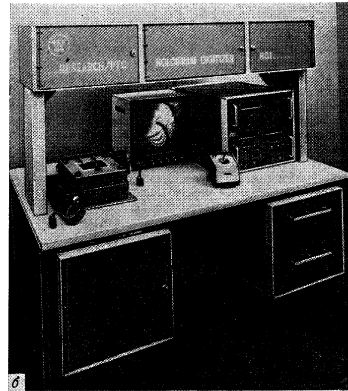
Рис. 5. а — схема полуавтоматического прибора для информационной расшифровки полос голограммы; б — внешний вид укомплектованного прибора,
