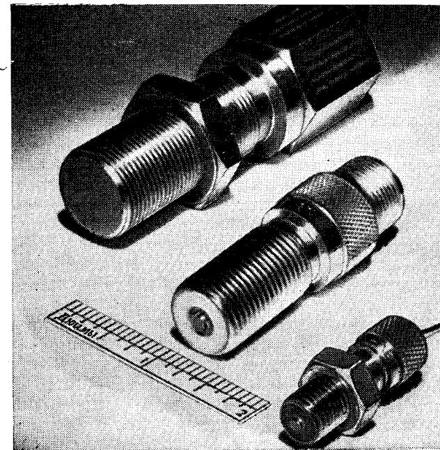
Рис. 6. Некоторые типичные магнитные возбудители, используемые при изучении вибраций.
