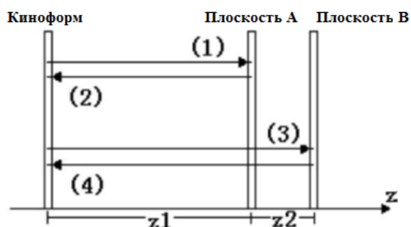
Рис. 2. Схема синтеза киноформ объемных сцен методом многих плоскостей
