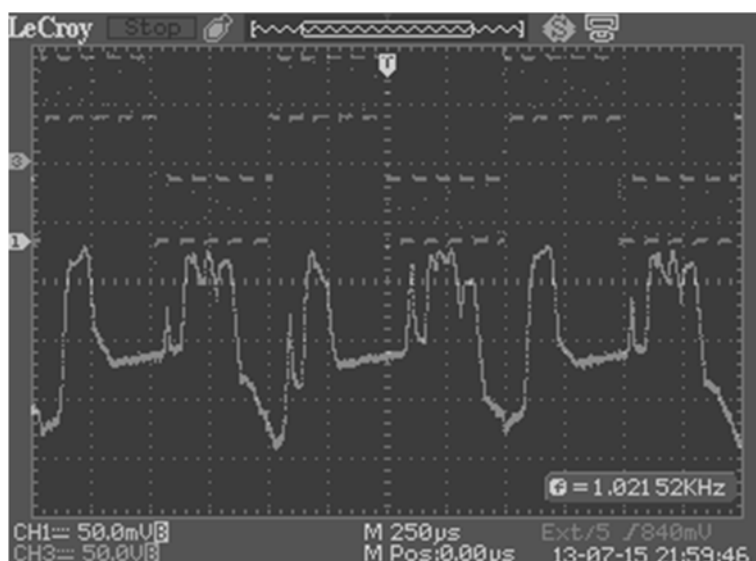
Рис. 2. Осциллограммы управляющего напряжения, приложенного к ячейке с негеликоидальным СЖК (вверху), и оптического отклика — модуляции фазовой задержки (внизу)
