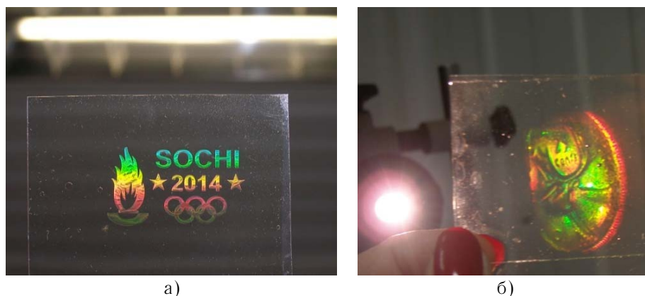
Рис. 2. Элементы на основе объемной пропускающей дифракционной решетки (а) и голограммы сфокусированного изображения (б), восстанавливаемые в белом свете
