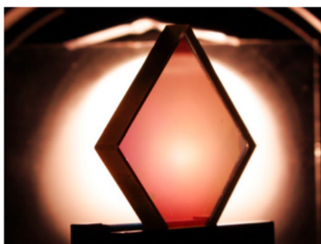
Рис. 4. Фотография образца в ТМ-поляризованном проходящем свете при угле поворота 60^\circ
