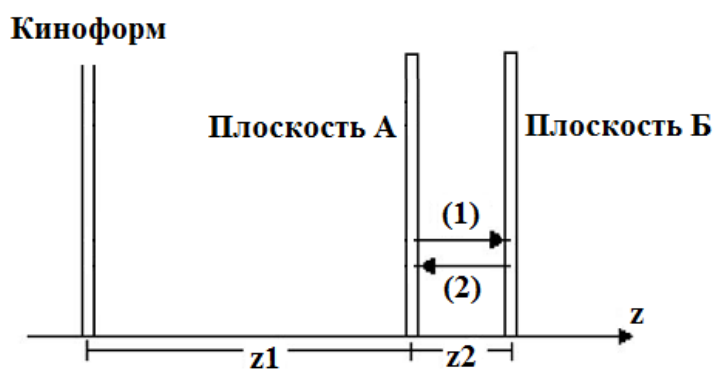
Рис. 1. Схема синтеза киноформов объемных сцен методом «пинг-понг»
